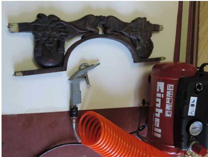
A nehezen hozzáférhető, restaurálás alatt álló törékeny darabok portalanításához és favédőszerrel történő felhordásához nélkülözhetetlen a magasnyomású levegőfúvó kompresszor.
