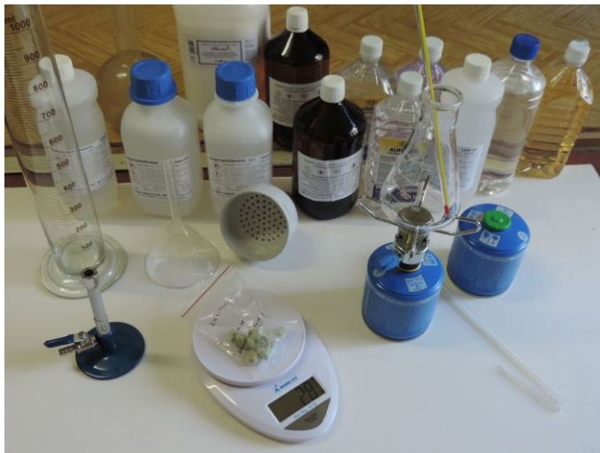
Resturáláshoz a legkülönbözőbb eszközök használatosak, úgy mint a bunsen égő, digitális mérleg, üveg lombikok, gázmelegítő, hőmérő, tölcsérek. Vegyszerek mint például alkonek, terpentin, izopropil, denaturált szesz, aceton, lekkbenzin, plectol...
